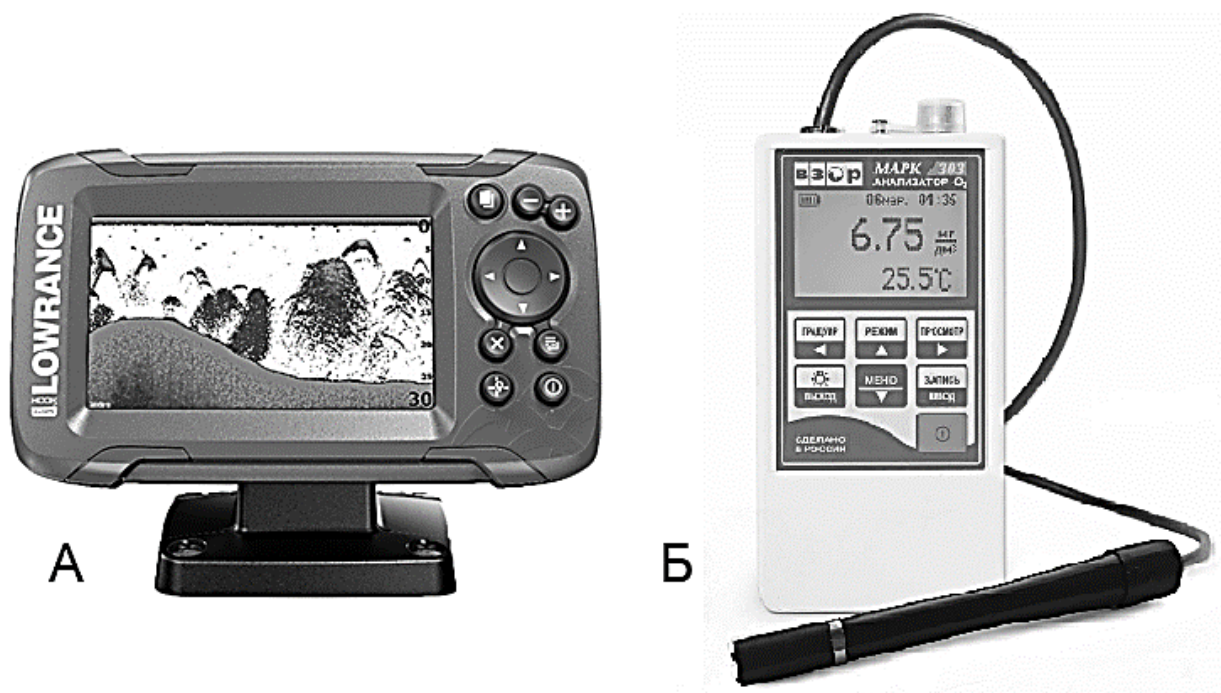
Рис. 5. Примеры приборов для измерения глубины (А) и растворенного в воде кислорода (Б)
